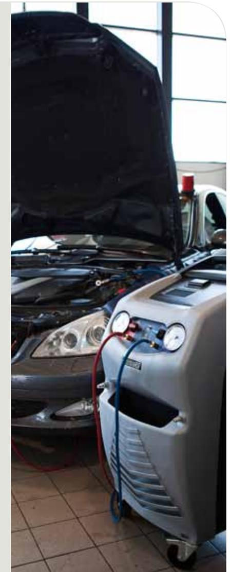
Apparecchiatura completamente automatica per il recupero, riciclo e ricarica di refrigerante R134a per autobus e mezzi pesanti.
