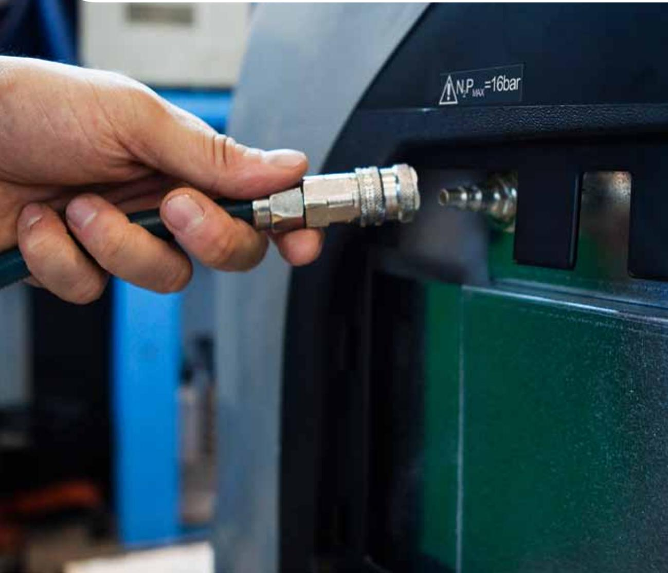
Il controllo delle perdite con azoto è un sistema alternativo ai metodi tradizionali di ricerca fughe (controllo durante la fase di vuoto o tracciante). Il vantaggio di utilizzare l'azoto è quello di poter controllare le perdite in **pressione** con un gas **inerte**, soprattutto nei casi in cui l'uso di tracciante non è consentito (ad es. case automobilistiche).
