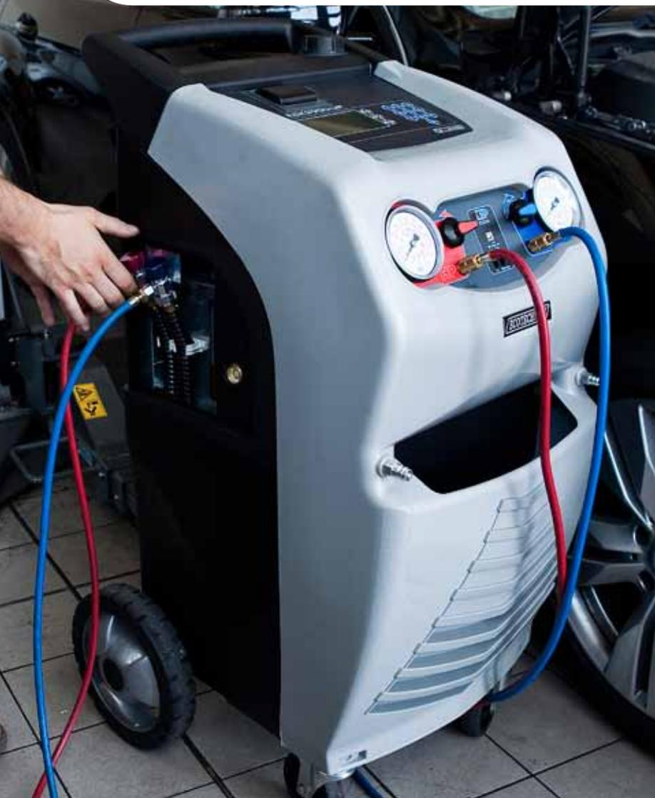
I nuovi impianti A/C che equipaggiano molti veicoli di ultima generazione, ad es. i **veicoli ibridi o elettrici**, sono dotati di un compressore azionato da un motore elettrico ad **alta tensione**, contenente uno specifico olio ad elevato **isolamento elettrico**. L'uso di altri oli può essere pericoloso per
